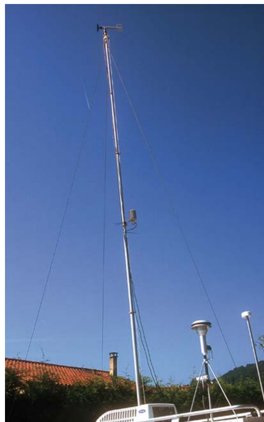
Station de mesure pour la qualité de l'air et les pollutions atmosphériques. COPARLY.
